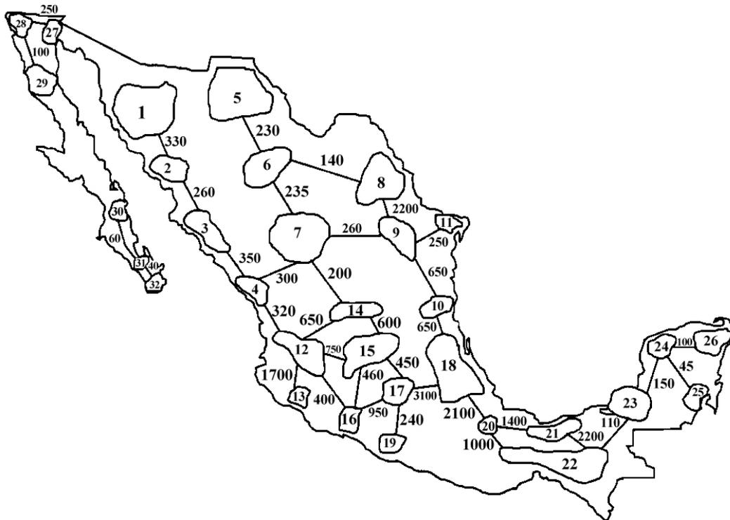
Figura 2.4. División del Sistema Eléctrico Mexicano en áreas y se muestra la capacidad en las interconexiones en 1998 (Adaptado de [Madrigal et al., 2004]).
